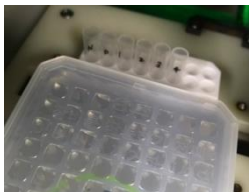
Fig. 30 Carga de la Gradilla de tubos de la muestra
