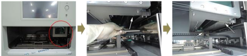
Fig. 49 Paso 1 de Descontaminación; Separación e instalación del Protector de contaminación
