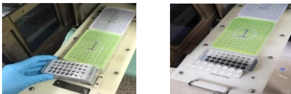
Fig. 24 Inserción de las Puntas desechables en la Gradilla de puntas desechables.
