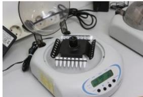
Fig. 41 Mezcla de la tira de Premezcla PCR utilizando el *ExiSpin*<sup>™</sup>.
