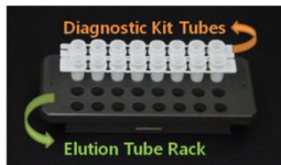
Fig. 57 Chequeo de la posición de los tubos del kit de diagnóstico en la gradilla de los tubos de elución
