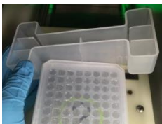
Fig. 29 Remoción de la bandeja de desperdicios
