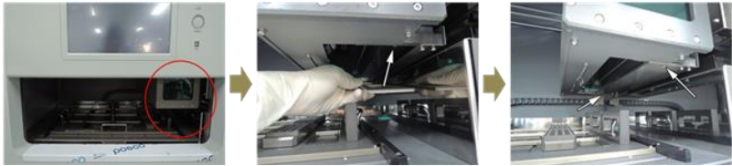
Fig. 52 Paso 1 de descontaminación; Separación e instalación del Protector de contaminación
