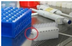
Fig. 65 Cerrojo para retener el Tubo de Carga de la muestra
