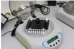
Fig. 41 Mezcla de la tira de Premezcla PCR utilizando el ExiSpin™ .
