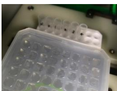
Fig. 30 Instalación de la Gradilla de tubos de la muestra
